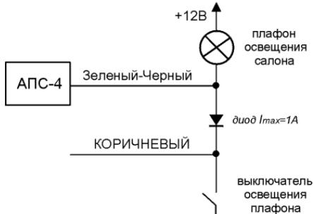
2. Рекомендуемая схема подключения КОРИЧНЕВОГО провода системы ("отрицательный триггер двери") к проводке автомобилей ВАЗ семейства 2110 и 2115, оснащенных иммобилайзерами АПС-4:
