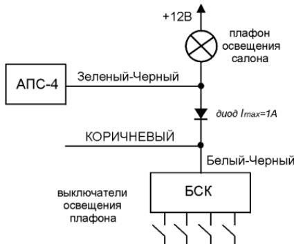
3. Рекомендуемая схема подключения ТЕМНО-ЗЕЛЕННОГО провода системы ("отрицательный триггер капота/багажника") к подкапотной лампе автомобилей ВАЗ семейств 2109, 2115, 2123 или лампе освещения багажника автомобилей ВАЗ семейства 2115:
