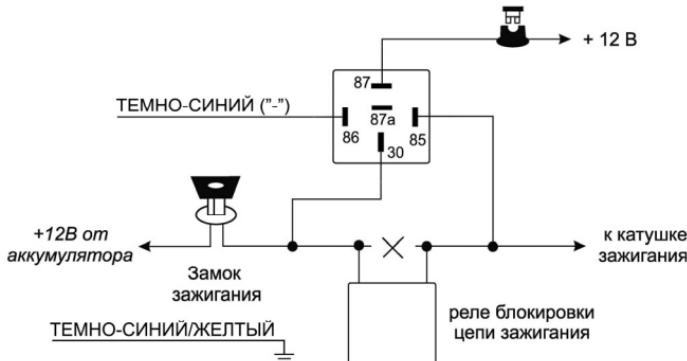
4) Вы можете также использовать выход дополнительного канала 2 системы для **ручного включения режима "турбо"** при установке системы на автомобиль с двигателем, оснащенным турбонаддувом
