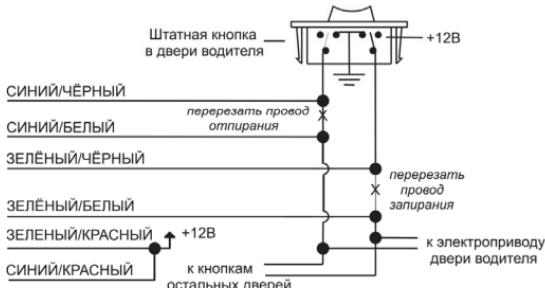
6) 5-проводная система центрального замка с управлением запиранием дверей по плюсу и отпиранием дверей импульсом переменной полярности
